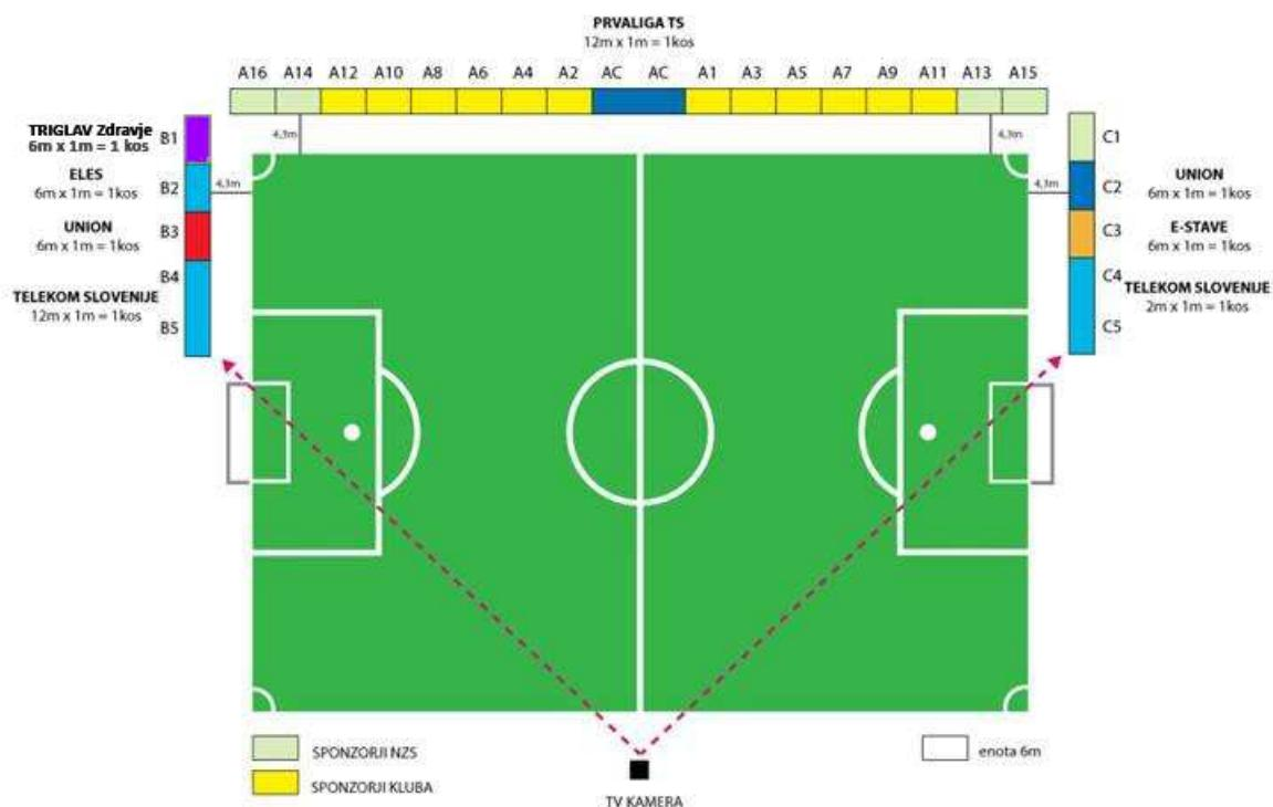
**Postavitev statičnih panojev po pravilih UEFA mora biti 4,30 metrov od zunanje črte igrišča.**
